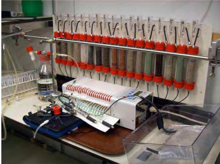
Abb. 6: Laboraufbau für Säulenversuche zur Untersuchung von Gatematerialien.
