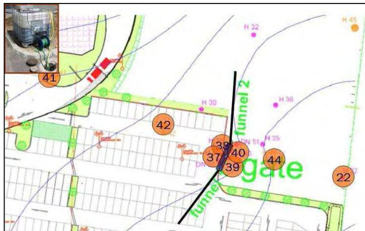
Abb. 9: Ausschnitt des Untersuchungsgebietes mit Melasse-Dosierstation bei H41, ausgewählten Messpegeln und Funnel&Gate Anlage (unbefülltes Gate während der Melassedosierung).
